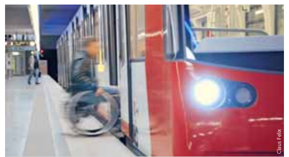
Die Spaltüberbrückung bereitete anfangs Probleme. Jetzt setzt sie Standards.
