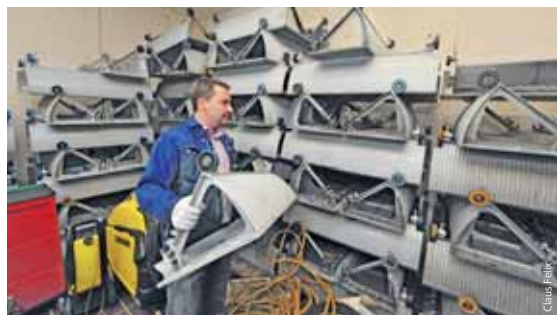
Frank Nowag lagert im Keller alte Fahrtreppenstufen als Ersatzteile.
