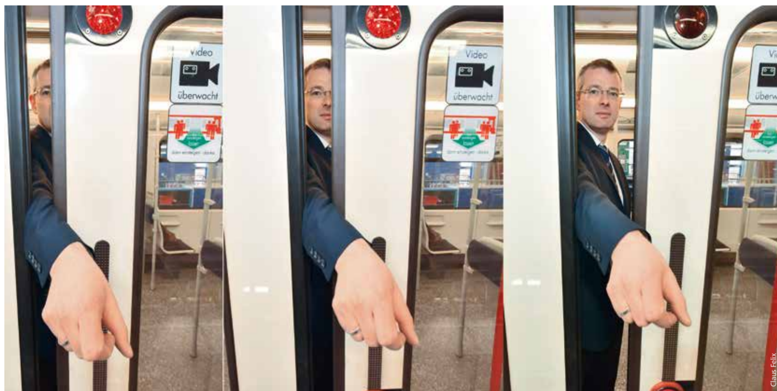
Der Türschließmechanismus reagiert auf dünne wie größere Gegenstände. Die Türen öffnen sich dann automatisch und der Zug fährt nicht an.
