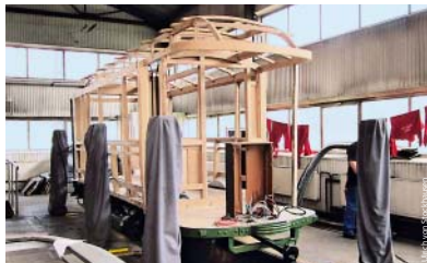
Der Beiwagen 336 nimmt mit dem Wagenkasten aus Eiche Gestalt an.
