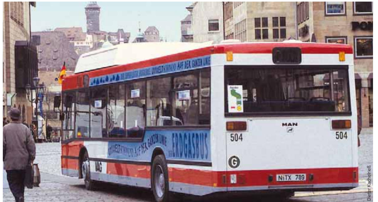
Die VAG gibt seit den 1990ern umweltschonend Gas. Bei Erdgasbussen ist der Speicher auf dem Dach.
