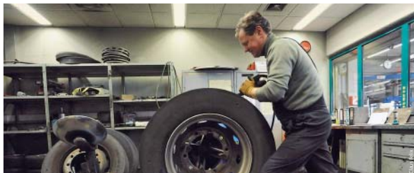
Damit die Reifen bei Schnee und Eis eine starke Haftung haben, werden sie für den Winter neu profiliert.
