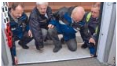
Die Spaltüberbrückung garantiert Sicherheit und bequemes Einsteigen.
