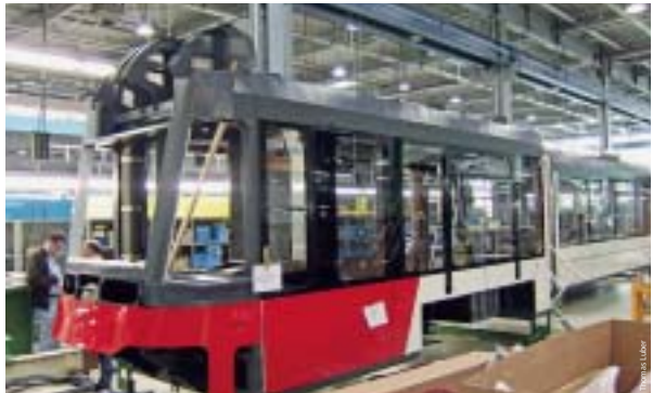
Die neue Variobahn in der Montagehalle der Firma Stadler Pankow GmbH nimmt inzwischen deutliche Formen an.
