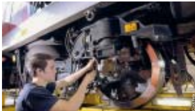
Harald Distler von der U-Bahn-Werkstatt beim Einbau eines Getriebes.
