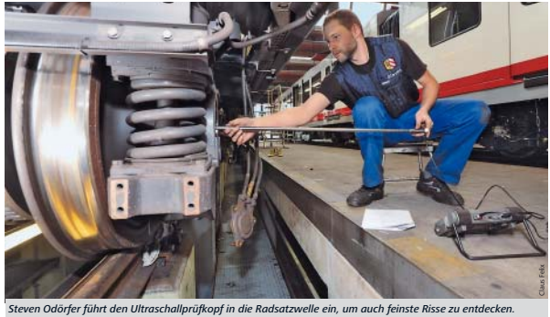
Steven Odörfer führt den Ultraschallprüfkopf in die Radsatzwelle ein, um auch feinste Risse zu entdecken.
