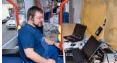
Bei Bremstests simulieren Sandsäcke das Gewicht der künftigen Fahrgäste.
